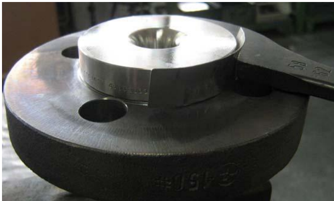
Abb.3 Montage der Sitzbuchse
